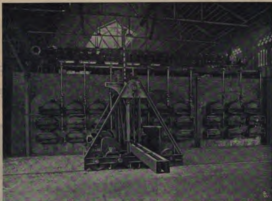
Fotografia della macchina a scaricare le storte installata nell'Officina del Gas a Gracia - Barcellona.
